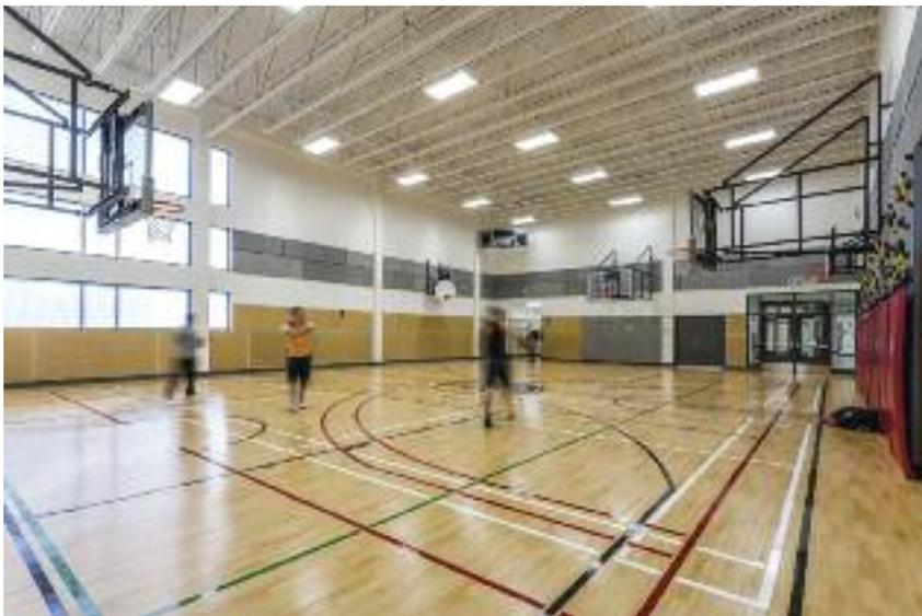
Le bâtiment Field House est un bâtiment d'acier préconçu muni d'une structure rigide à grande portée. Le toit du système de construction en acier (SBS), qui abrite le terrain de soccer, est blanc clair, ce qui remplit les critères d'effet d'îlot thermique élaborés par LEED. Le toit utilise aussi les systèmes Thermalguard et Vapourguard 32 de Behlen Industries.
