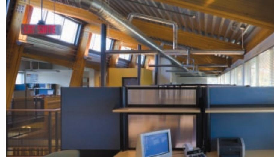
L'intérieur de l'édifice s'articule autour d'un atrium éclairé par des fenêtres hautes exposées au nord qui met en relief la charpente de lamellés-collés et le platelage de tôle apparent, et procure une continuité visuelle entre les aires à plancher ouvert.
