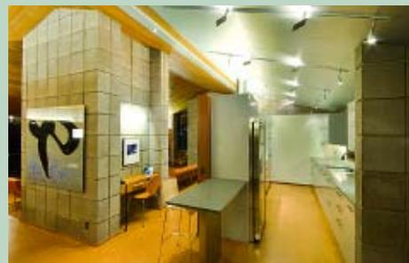
Le traitement de plafond en acier Galvalume de la cuisine permet de réfléchir la lumière vers les surfaces de travail et s'étend jusqu'à l'extérieur en traversant le vitrage afin de recouvrir la soffite. À l'extérieur, l'acier élève la bordure de toit tout en cachant une gouttière intégrée et se transforme en toiture d'acier Galvalume à joint debout.
